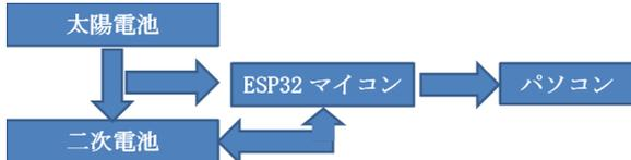
図1 製作ユニットの構成図
