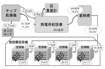
図 1. 熱電併給熱利用システム
