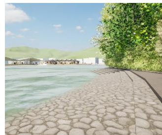
図 15：石積み傾斜護岸
