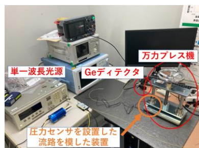
図 3 MMI センサによる BSA 測定 実験系
