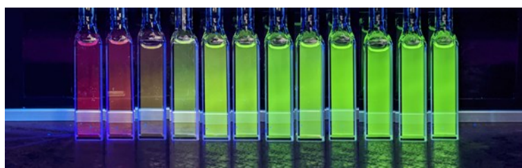
Figure 2-33. 室温アセトニトリル中における 1F の吸収 (左)・蛍光スペクトル (右、励起波長：400 nm) の TFA 濃度依存性 ( [1F] = 1.03 \times 10^{-5} \text{ M} 、黄緑色→黒色： [TFA] = 0\text{--}10 \text{ mM} ) および発光の様子 (左から順に [TFA] = 0\text{--}10 \text{ mM} ) .
