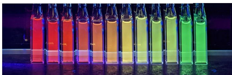
Figure 2-36. 室温アセトニトリル中における 1CN の吸収 (左)・蛍光スペクトル (右、励起波長：400 nm) の TFA 濃度依存性 ( [1CN] = 1.04 \times 10^{-5} \text{ M} 、青色→黒色： [TFA] = 0\text{--}10 \text{ mM} ) および発光の様子 (左から順に [TFA] = 0\text{--}10 \text{ mM} )。
