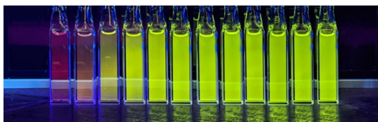
Figure 2-31. 室温アセトニトリル中における 1Me の吸収 (左)・蛍光スペクトル (右、励起波長：400 nm) の TFA 濃度依存性 ( [1Me] = 1.06 \times 10^{-5} \text{ M} 、橙色→黒色： [TFA] = 0-10 \text{ mM} ) および発光の様子 (左から順に [TFA] = 0-10 \text{ mM} )。
