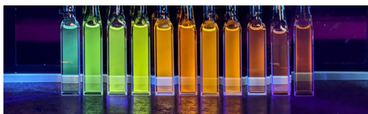
Figure 3-14. 2a の吸収（破線）および蛍光（実線）スペクトルの溶媒依存性（上）と蛍光の様子（下）. スペクトルの色はトルエン（紫）、1,4-ジオキサン（青紫）、クロロホルム（青）、酢酸エチル（水色）、テトラヒドロフラン（青緑）、ジクロロメタン（緑）、1,2-ジクロロエタン（黄色）、アセトン（橙）、 N,N -ジメチルホルムアミド（赤橙）、ジメチルスルホキシド（赤）、アセトニトリル溶液（茶色）に対応する.
