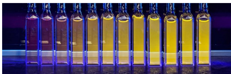
Figure 2-30. 室温アセトニトリル中における 1OMe の吸収(左)・蛍光スペクトル(右、励起波長：410 nm) の TFA 濃度依存性 ( [1OMe] = 1.06 \times 10^{-5} \text{ M} 、赤色→黒色： [TFA] = 0-10 \text{ mM} ) および発光の様子 (左から順に [TFA] = 0-10 \text{ mM} ) .
