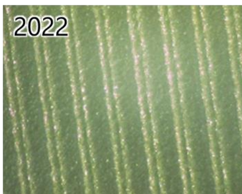
図 6.3 加工精度の悪い 2022C1 基板
