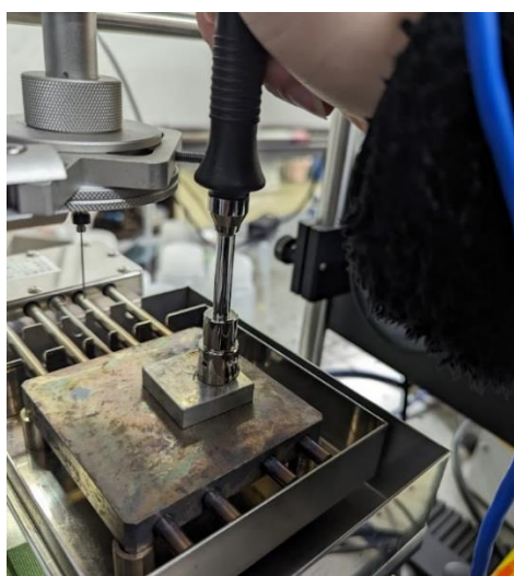
図4.5 R_{neck} 計測実験の基板温度計測
