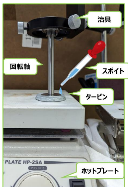
図 7.6 試作したタービンを用いて排熱の回生に挑戦する際に用いた実験系
