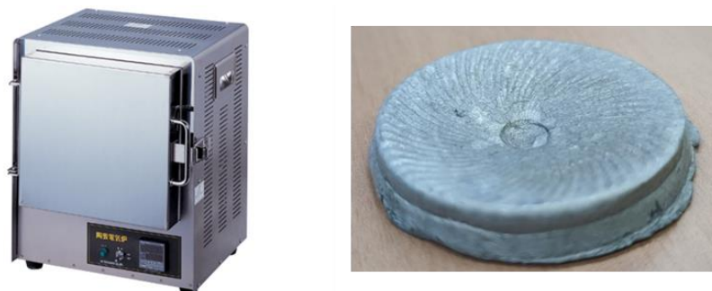
図 7.5 卓上小型電気炉(NHK-170 型)と試作したタービン
