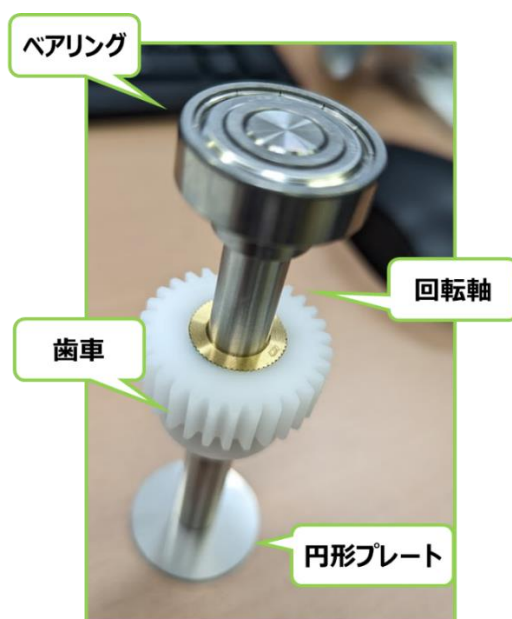
図 7.3 完成した排熱回生システムの軸部分
