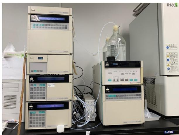
図 7 HPLC(高速液体クロマトグラフィーD-7000)
