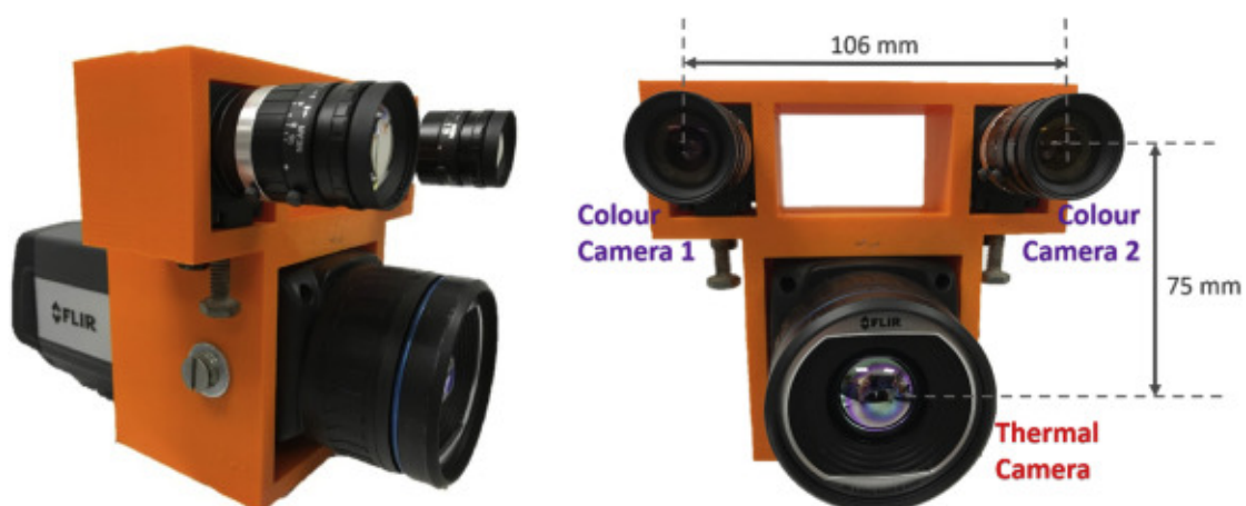
図 1.4: 2 台のカラーカメラとサーモカメラを搭載したフレーム
