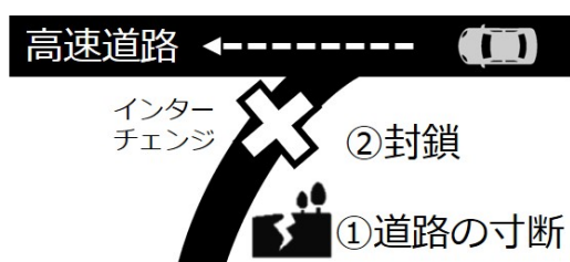
図 4.7 高速道路侵入経路での道路の寸断例 1
