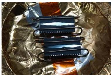
図 1. スパッタ基板とマスクサンプルのクリップ固定図
