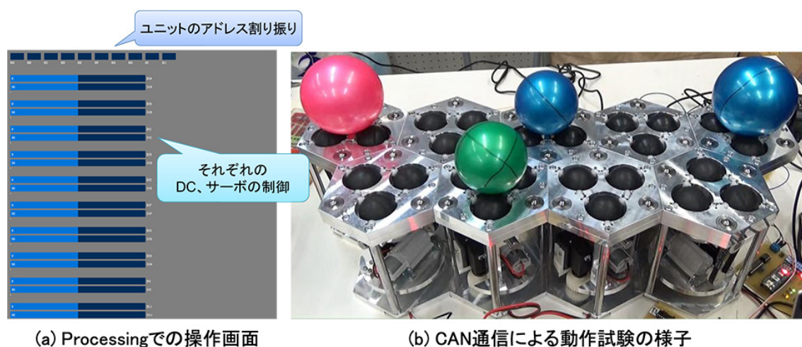
図 1.17 CAN 通信による動作試験
