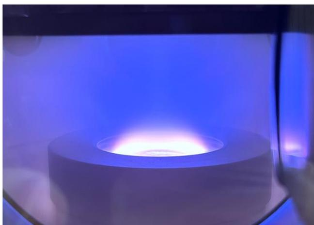
図 2-1 DC スパッタによって発生させたプラズマの様子
