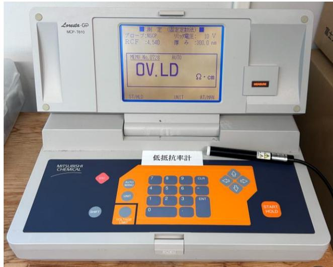
図 2-10 本研究で使用した低抵抗率測定装置
