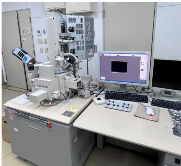
図 2-5 本研究で使用した SEM 装置(HITACHI SU8020)
