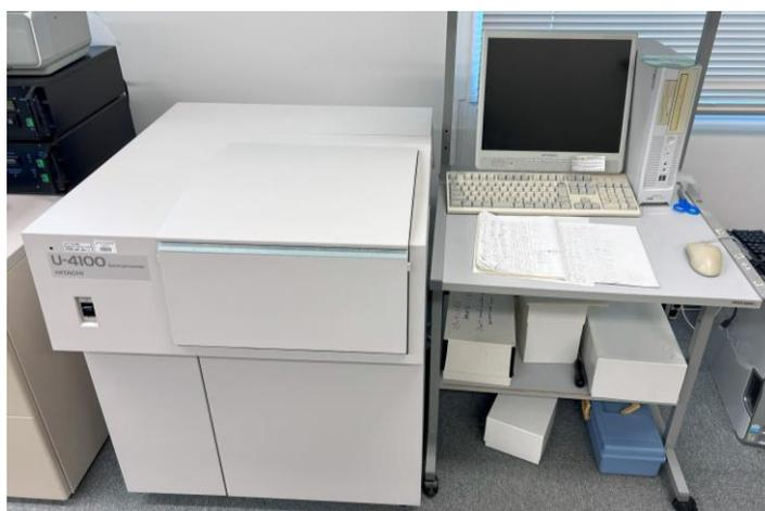
図 2-8 本研究で使用した分光光度計(HITACHI U-4100)
