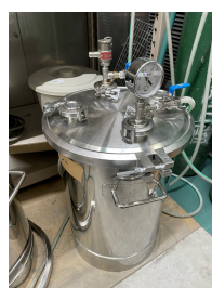
写真-1 加圧容器
