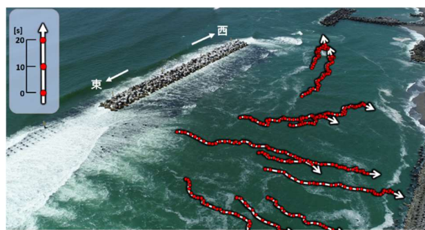
図8, 流れの動きの分析結果
