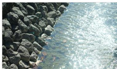
図 5. PL フィルター有り横スリット画像横スリットで反射を強調させて撮影すると、水底の形状の写り込みが少ないことがわかった。
