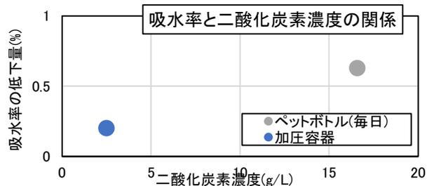
図-6 吸水率の低下量と二酸化炭素濃度の関係
