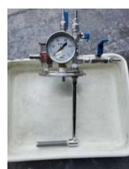
写真-4 改良型加圧容器内部
