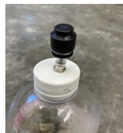
写真-4 逆止弁を取り付けたペットボトルのキャップ
