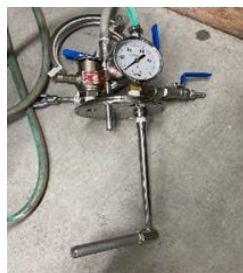
写真-3 改良型加圧容器の内部
