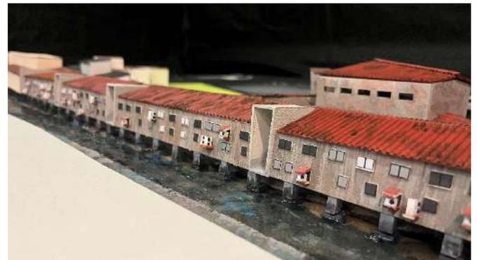
図 13：防火壁となるコンクリートボックス模型写真
