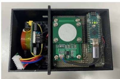
図 3 INF03S とその他のセンサ類を一つにまとめた BOX 内の外観(実験中は蓋をする)
