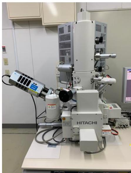
図 2.3 走査型電子顕微鏡(FE-SEM SU-8020)
