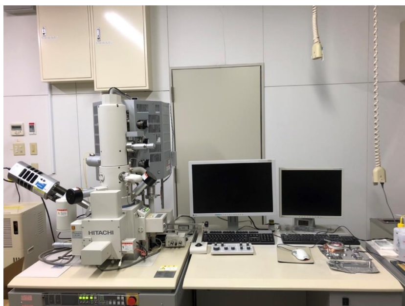
図 2.5 電界放出型走査電子顕微鏡 SU8020 型 (Hitachi High Technology, FE-SEM)の外観
