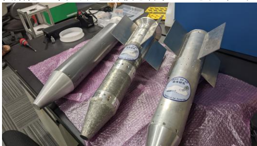
図1 ペネトレータの外観.南極で使用したペネトレータで、鉛筆形状をしており、その大きさは、最大直径(フィンを含む)が130 mm、長さが800 mmである。
