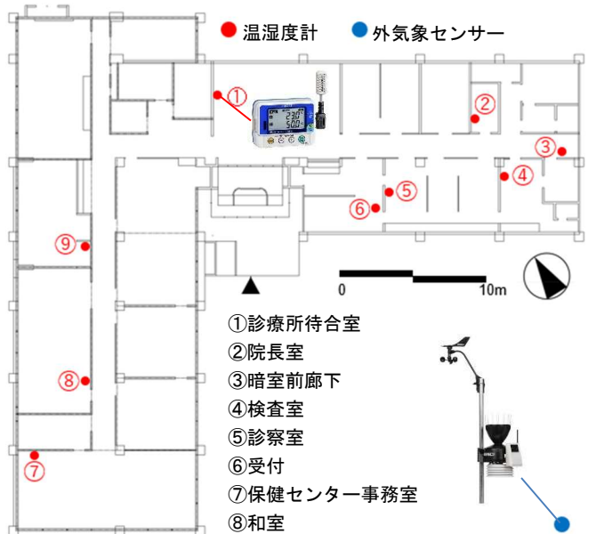
図 2 屋内温湿度計・外気気象センサーの設置箇所
