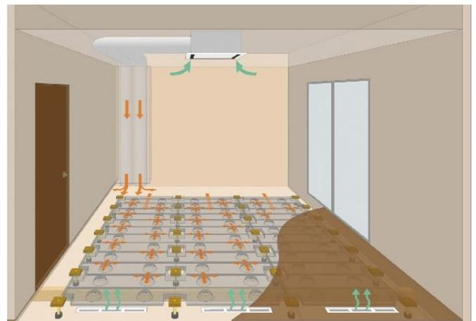
図2 空気式床下空調システム構成図
