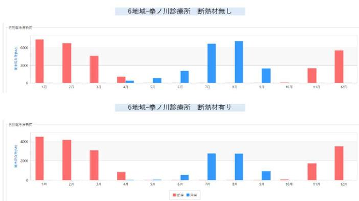
図 11 年間の暖冷房負荷 (上段:断熱無し 下段:断熱有り)
