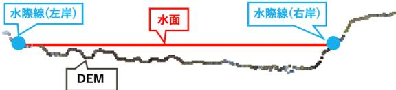
図7 点群から作成したDEMと水面
