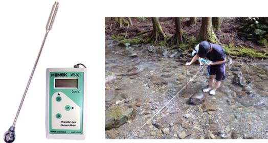
図2 プロペラ式流速計(KENEK VR-301)と計測風景
