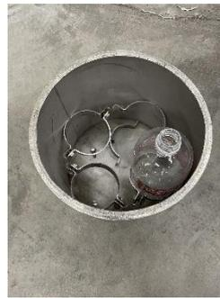
写真-1 ペットボトルを固定した回転専用の容器
