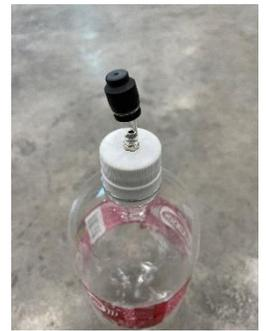
写真-2 逆止弁を取り付けたキャップ
