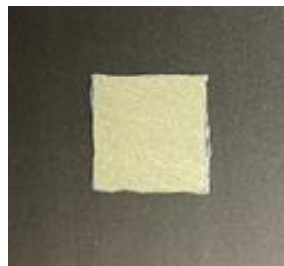
図 2.10 作製した 0-3 圧電複合材+グラファイト試験片
