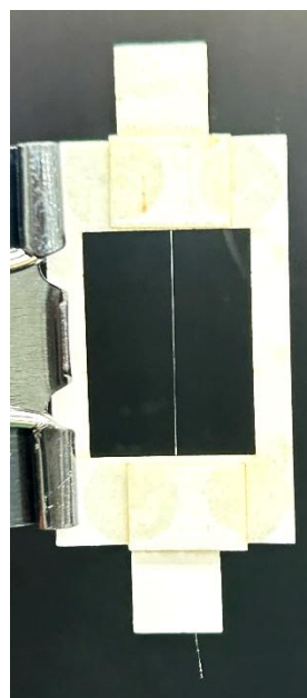
図 2.4 ガラス繊維貼り付け
