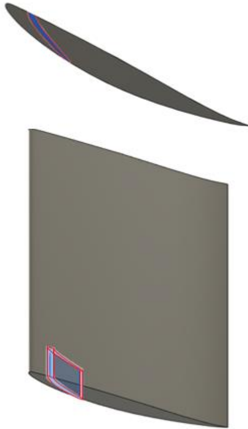
図 3-3. 翼背面の溝幅を絞り前縁に配置した溝形状モデル(Model 1)
