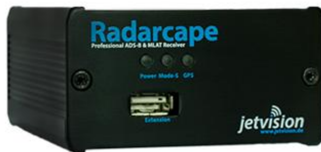
図 2 Radarcape ADS-B 受信機の正面図
