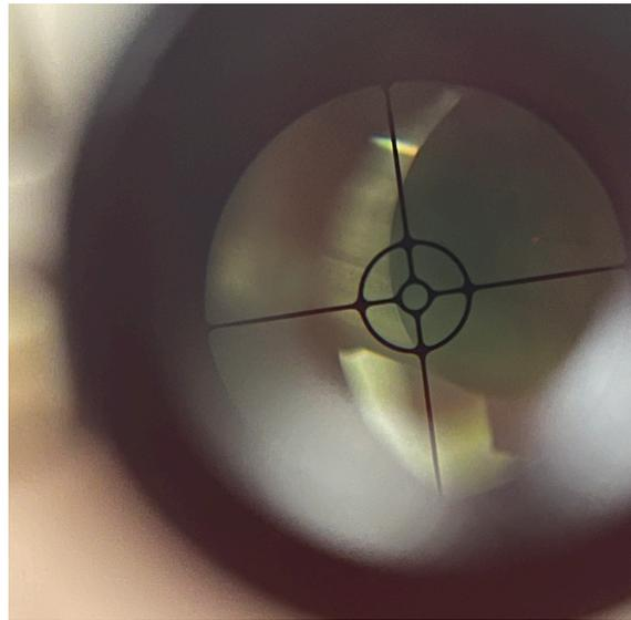
図 3.28 放射温度計覗き窓から供試体表面の測定位置の確認
