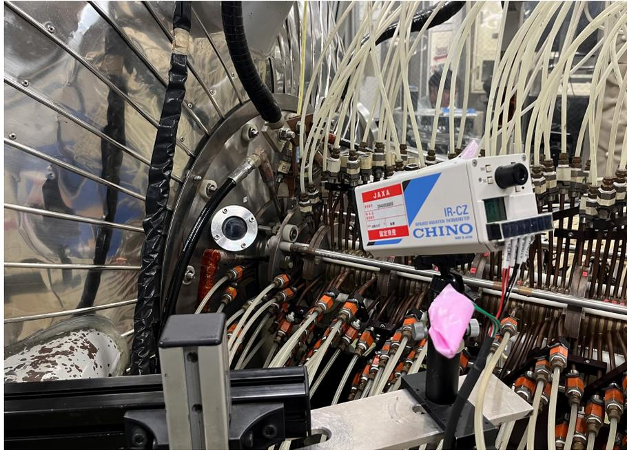
図 3.27 放射温度計の設置位置
