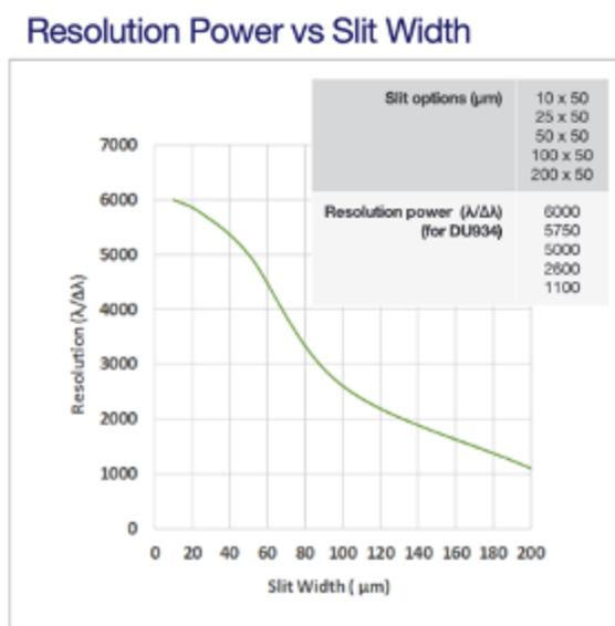
図 3.13 Mechelle5000 解像度とスリット幅の対応 [28]
