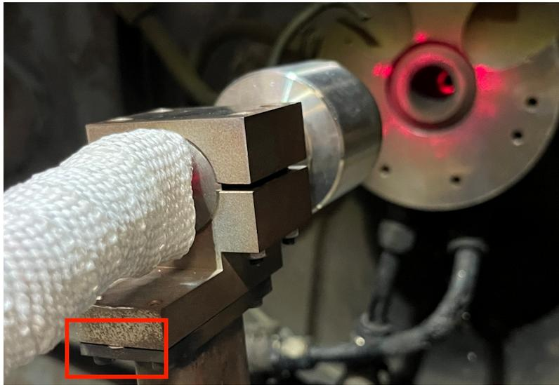
図 3.24 CY0 光線中心位置の上下方向の調節の様子
