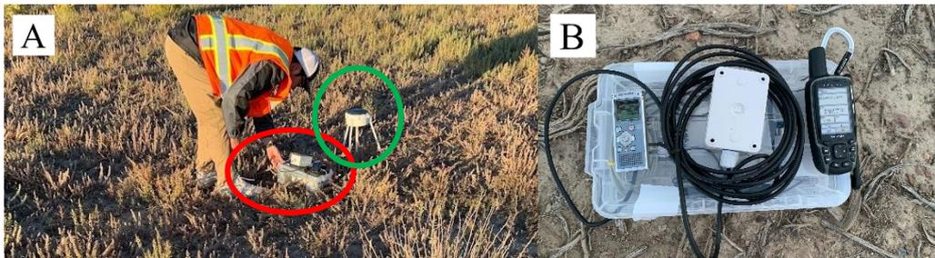
図 2-5. センサセットを設置している様子. A の赤丸内が当研究室のセンサであり, 緑丸内が他研究機関設置のセンサ. B は INF04 セットと可聴音マイク (赤枠内) を設置したさいの様子.
