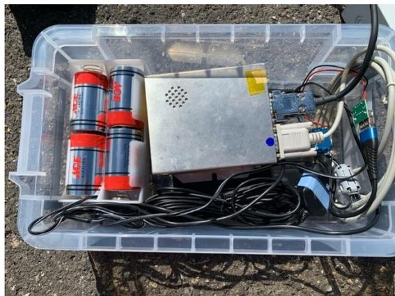
図 2-3. INF04 セットの様子。ボックス内にデータロガー，電源，データロガー用 GPS アンテナ，INF04 を箱に入れた。INF04 用 GPS アンテナは収納できなかったため暴露状態にした。
