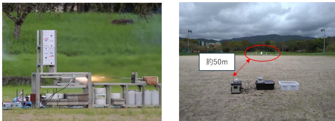
図 3.13 燃焼試験を行ったハイブリッドエンジン(左)とエンジンと観測地点の距離(右)
