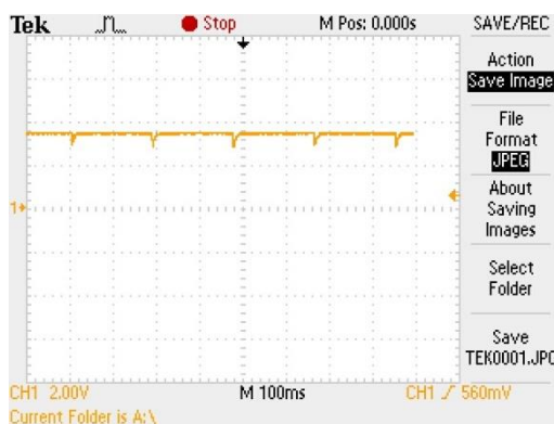
図 3.20 正常動作しなかったときの電源ラインの電圧波形
