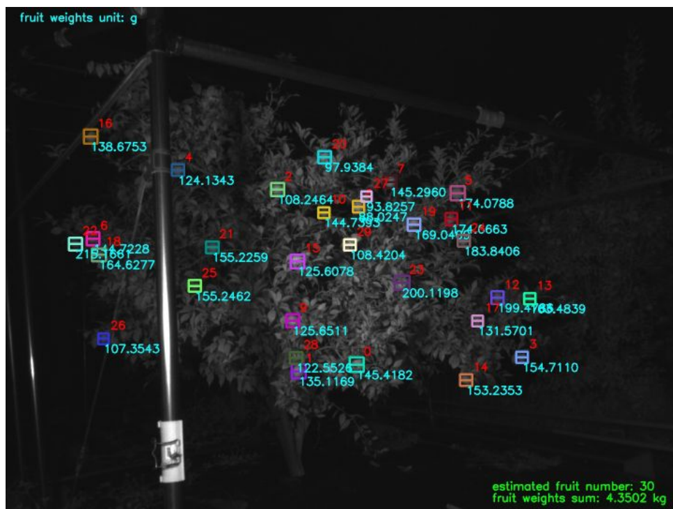
図 3.5 本手法による各果実の重量推定結果例
