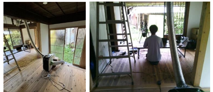
図12 使用した局所空調機と放射温度測定時の可視画像
