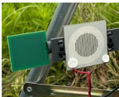
図-2 ACM センサ(右)および葉面濡れセンサ(左)
