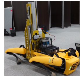
図 3 土壌硬度計測装置を搭載した Spot
