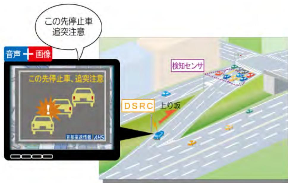
※画像センサで交差点手前の状況を検知し、停止車両がある場合は停止車両の存在を表す情報を、停止車両が無い場合は交差点の存在を表す情報をドライバーに提供する
